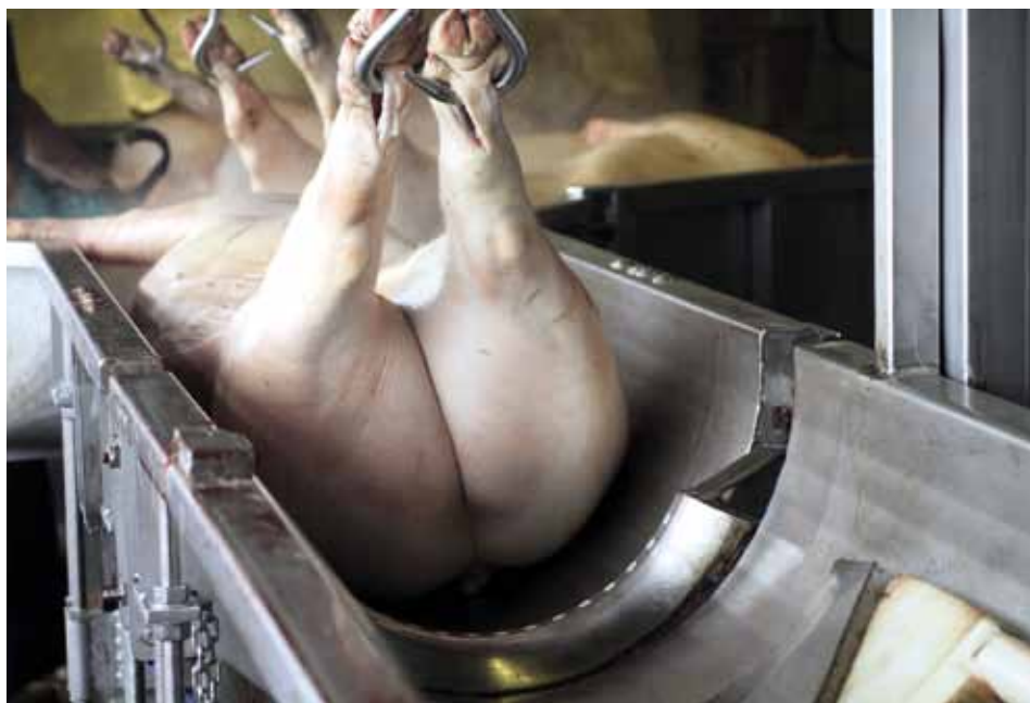
AutoFOM-III: Äußerlich unverändert geht AutoFOM in die dritte Generation. Das Prinzip der Ultraschallmessung ist geblieben, durch eine höhere Messdichte und -tiefe können jedoch noch präzisere Daten zur Klassifizierung gewonnen werden als bisher. Foto: Carometec
